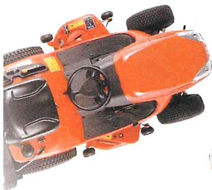
**2** Per permettere una curva stretta, le ruote anteriori girano con un incredibile angolo di 70°, momento in cui la ruota posteriore interna passa in folle.
